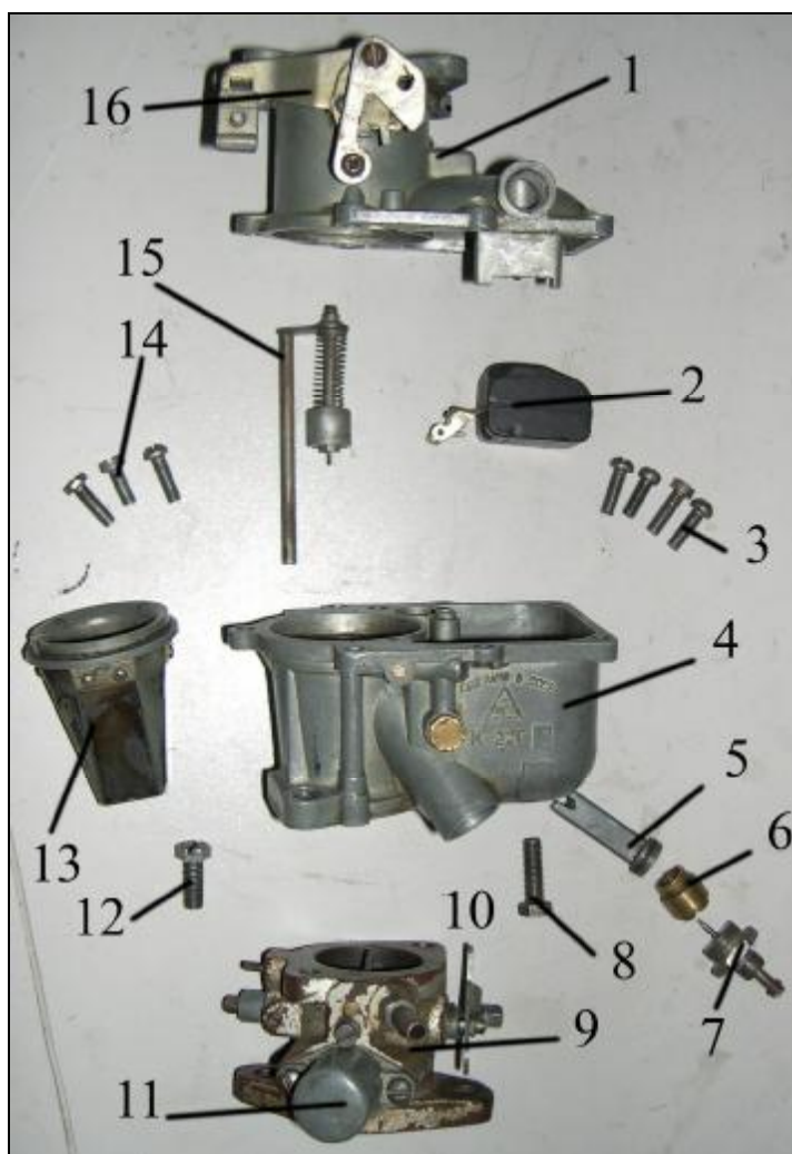
Hình 3.21. Các chi tiết và cụm chi tiết của bộ chế hoà khí
