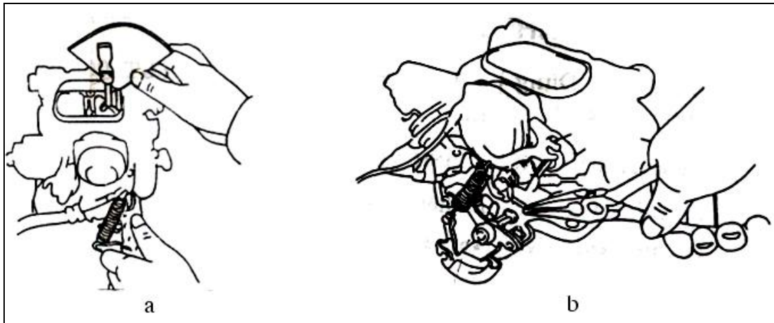
Hình 3.26. Điều chỉnh cơ cấu bướm gió
