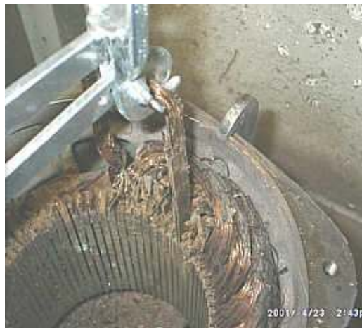
Hình 2-28. Rút dần từng bó dây ra khỏi lõi thép Stato
