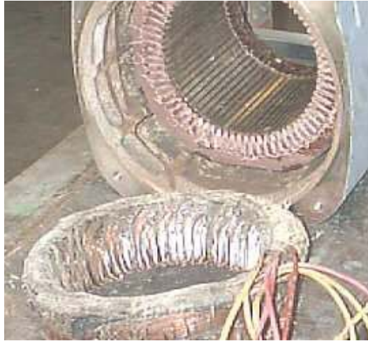
Hình 2-27. Phần đầu cuộn dây vừa cắt rời để kiểm tra sơ đồ đấu dây
