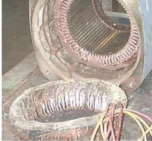
Hình 2-27. Phần đầu cuộn dây vừa cắt rời để kiểm tra sơ đồ đấu dây
