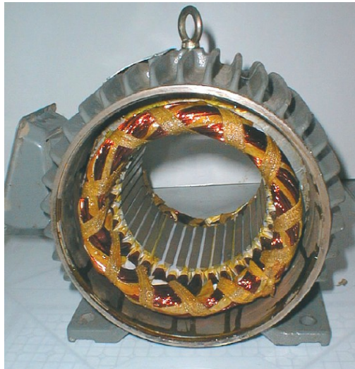
Hình 2- 39. Động cơ sau khi đã quấn hoàn chỉnh.
