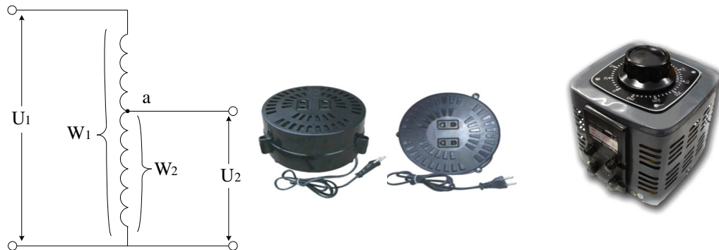
Hình 1.14. Sơ đồ nguyên lý máy biến áp Tự ngẫu và MBATN 1 pha
