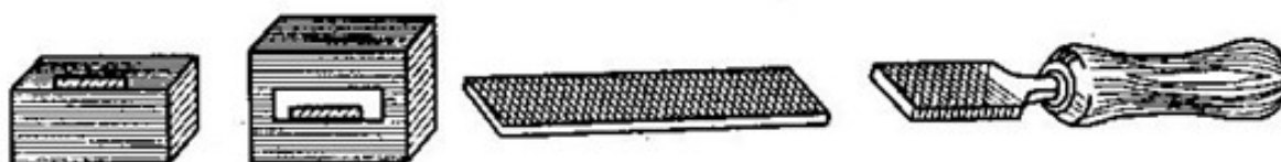
Hình 6.2 Cấu tạo dũa dẹt
