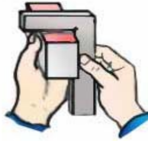
Hình 2.8. Cách kiểm tra vuông góc bằng ke góc 90 .
