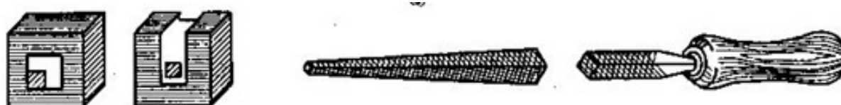
Hình 6.3. Cấu tạo dũa vuông.
