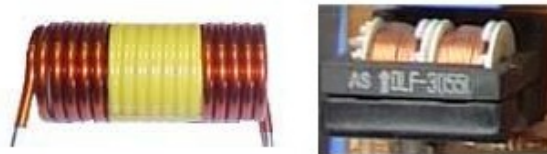
Hình 1.24: Hình dạng thực tế cuộn dây lõi không khí và cuộn dây lõi Ferrit
