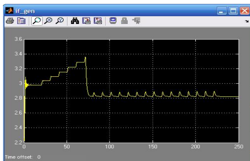
Dòng điện kích từ của máy phát điện
