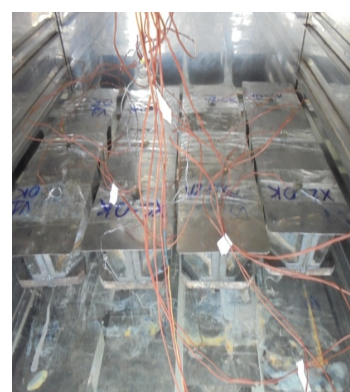
Hình 3. Mẫu được bảo dưỡng nhiệt ẩm
