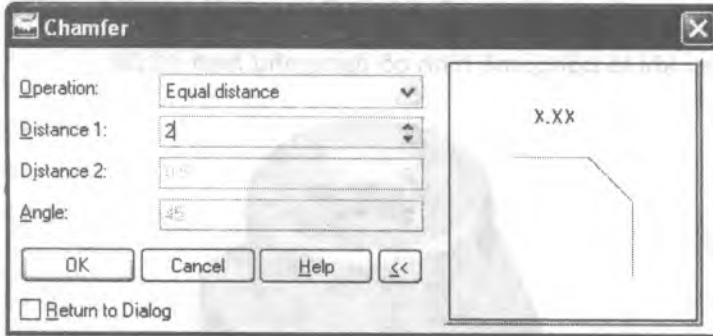
Hình 10.27 Hộp thoại Chamfer
