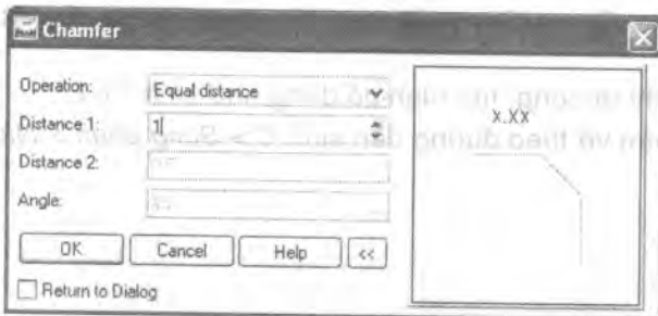
Hình 11.14 Hộp thoại Chamfer
