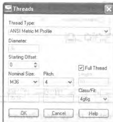
Hình 11.12 Hộp thoại Threads
