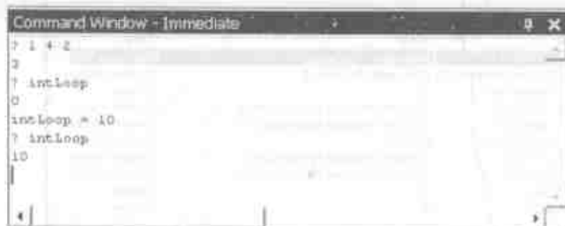
Hình 14: Cửa sổ Immediate hữu dụng cho việc kiểm tra các giá trị biến, gán các giá trị mới vào các biến và thực hiện các biểu thức.
