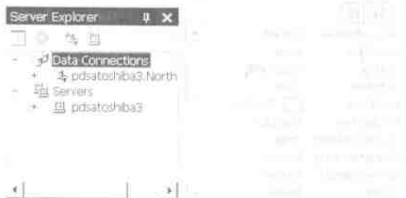
Hình 10: Cửa sổ Server Explorer trình bày danh sách các server, các CSDL, các bảng, các khung nhìn và các đối tượng CSDL khác.
