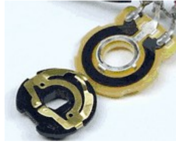
Cấu tạo trong triết áp
