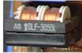
Hình 1.29 Cuộn dây lõi không khí Cuộn dây lõi Ferit
