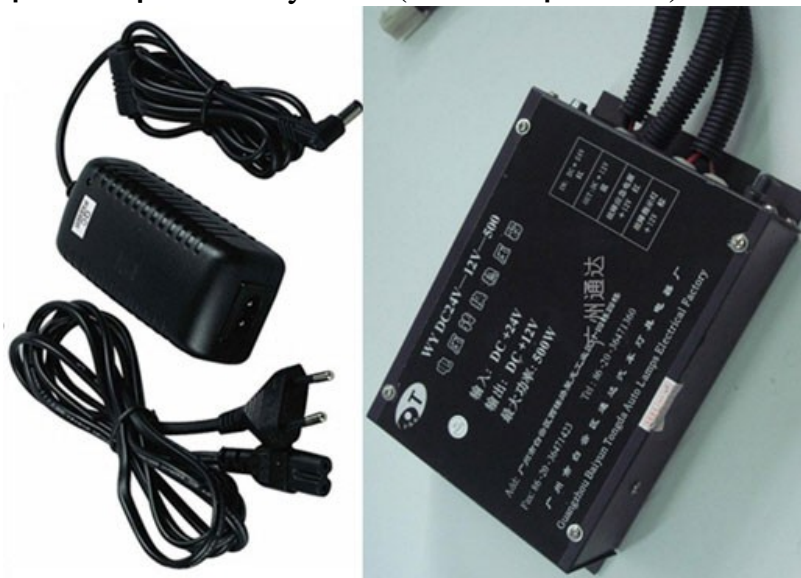
Mẫu adapter switching (trái) và regulator (phải)
