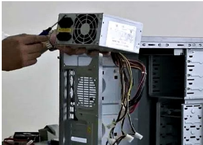
Hình: 2.1 Lắp ráp bộ nguồn
