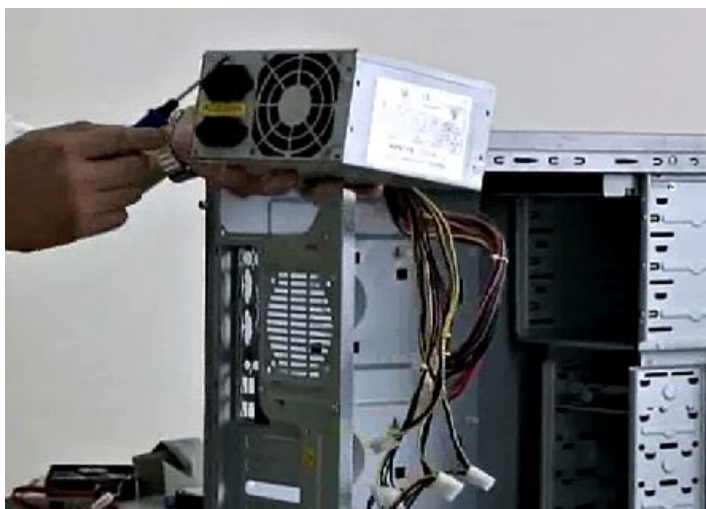
Hình: 2.1 Lắp ráp bộ nguồn
