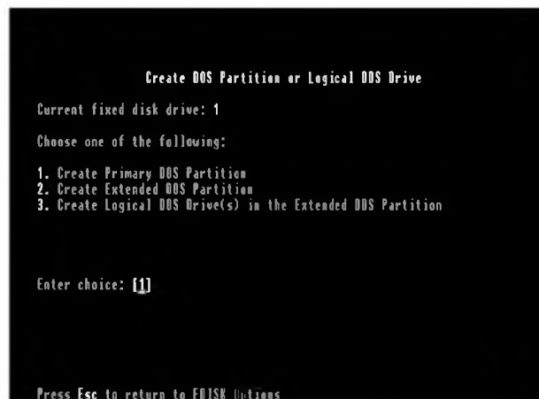
HÌNH 12: Menu FDISK để tạo các phân vùng và các ổ đĩa Logic
