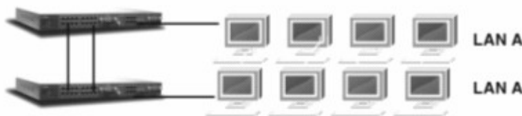
Hình 5.30 – Mô tả cách dùng đường Trunking .
