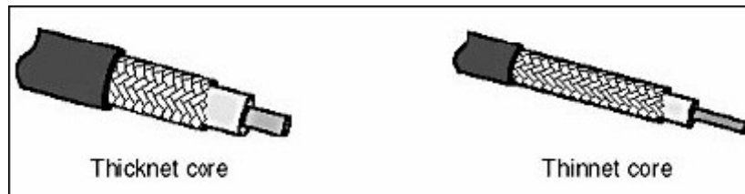
Hình 5.3 – So sánh cáp đồng trục: Thicknet và Thinnet .
