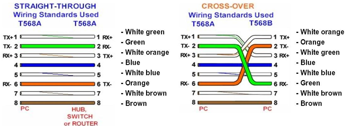
- Cáp thẳng theo chuẩn A và cáp chéo theo chuẩn A-B -
