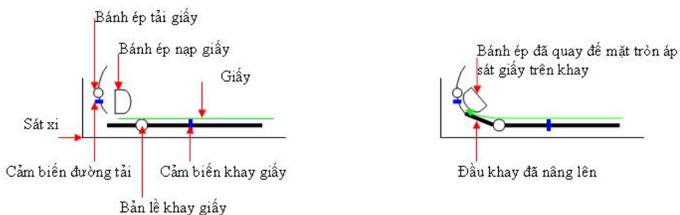
Cơ cấu nạp giấy loại khay giấy nằm (vào từ đằng trước máy)
