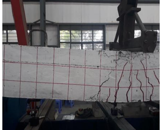
b) Vết nứt mặt tiếp xúc 2 lớp bê tông
