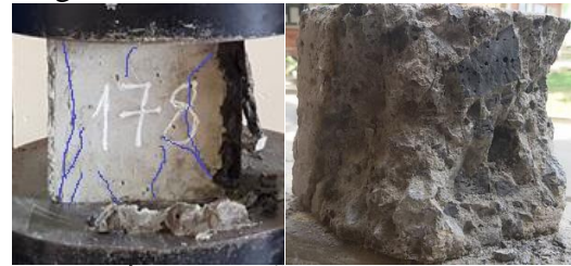
Hình 8. Vết nứt trên mẫu thí nghiệm thực nghiệm.
