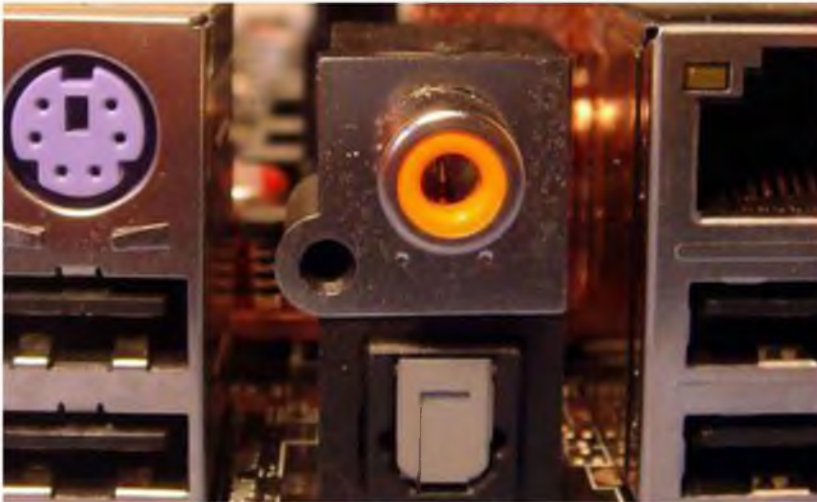
Hình 2 : Kết nối âm thanh dạng Digital ( Đồng trục bên trên , Quang bên dưới )
