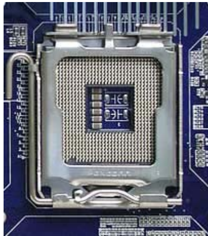
Đế cắm CPU - Socket 775 trong các máy Pentium 4 đời mới
