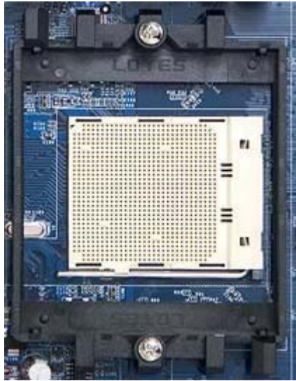
Để cắm CPU - Socket 939 trong các máy đời mới dùng chip AMD
