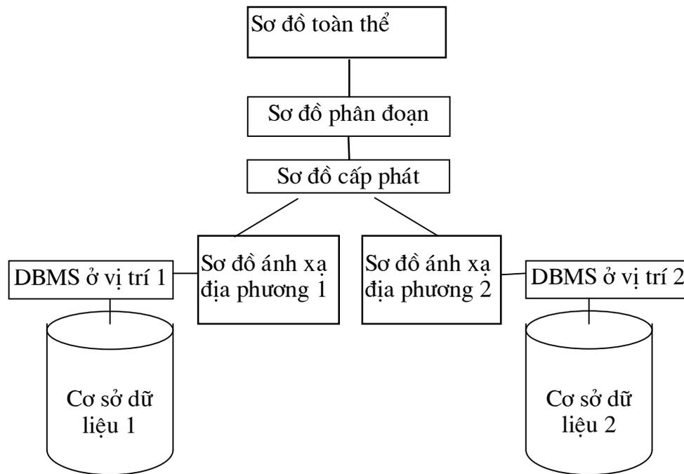
Mức đỉnh của lược đồ là sơ đồ toàn thể: Mô tả mọi dữ liệu nằm trong cơ sở dữ liệu phân tán như không bị phân tán. Tuy nhiên mô hình dữ liệu sử dụng để xác định sơ đồ toàn thể để xác định cách thức ánh xạ đến những mức khác của cơ sở dữ liệu phân tán. Theo cách sử dụng mô hình sơ đồ toàn thể, sơ đồ toàn thể xác định một tập các quan hệ chung nhất của hệ thống.
