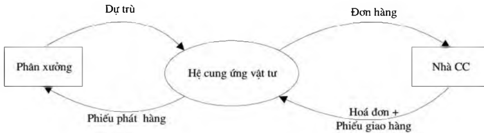
Hình 3.8. Mô hình dữ liệu mức khung cảnh của hệ cung ứng vật tư
