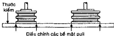
Hình 6-7. Kiểm tra sự thẳng hàng của dây đai
