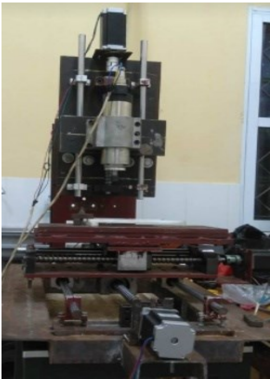
Hình 10. Hình ảnh hệ thống mô hình máy phay CNC 3 trục
