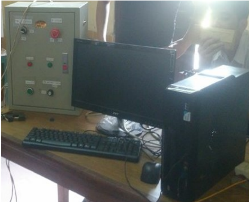
Hình 11. Hình ảnh hệ thống máy tính điều khiển mô hình máy phay CNC 3 trục
