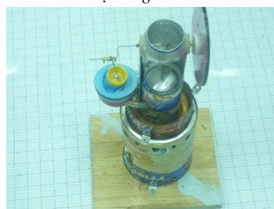
Hình 2. Động cơ Stirling
