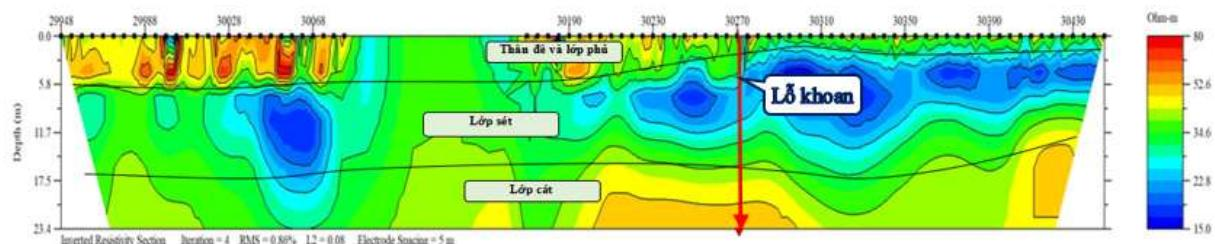
Hình 5. Kết quả khảo sát tuyến rìa phia đồng đoạn K29+950 - K30+450.
