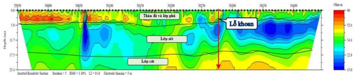
Hình 4. Kết quả khảo sát tuyến rìa sông đoạn K29+950 - K30+450.
