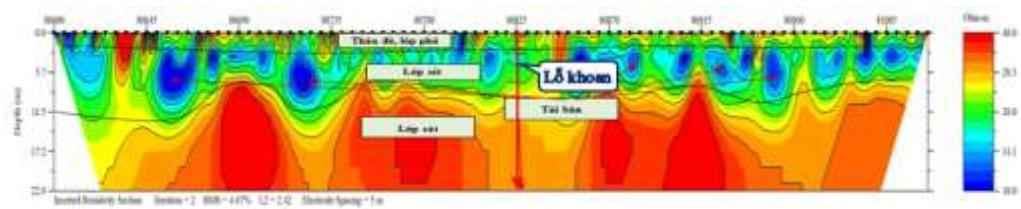
Hình 19. Kết quả khảo sát tuyến cơ phía đồng đê hữu Hồng đoạn K80+600 - K81+000.
