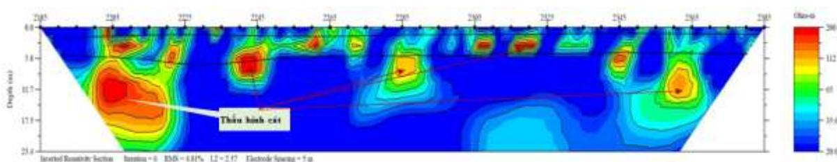
Hình 11. Kết quả khảo sát tuyến rìa sông đoạn K2+200 - K2+400.
