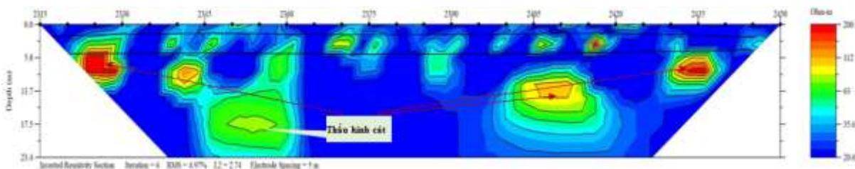
Hình 12. Kết quả khảo sát tuyến rìa phía đồng đoạn K2+300 - K2+450.
