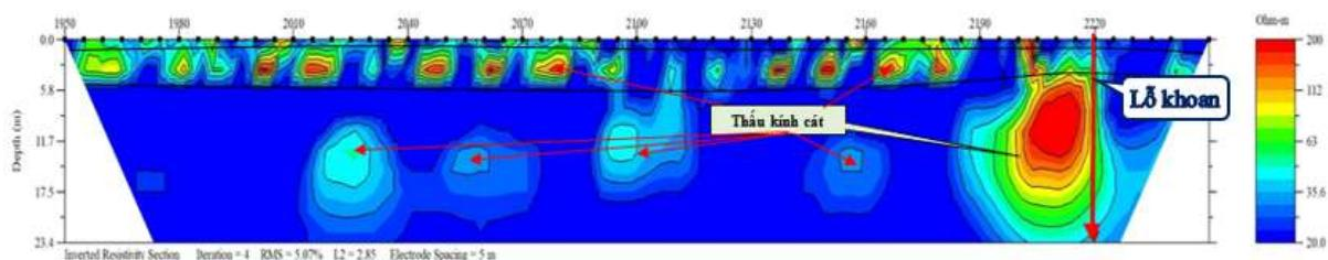
Hình 9. Kết quả khảo sát tuyến rìa sông đoạn K1+950 - K2+250.
