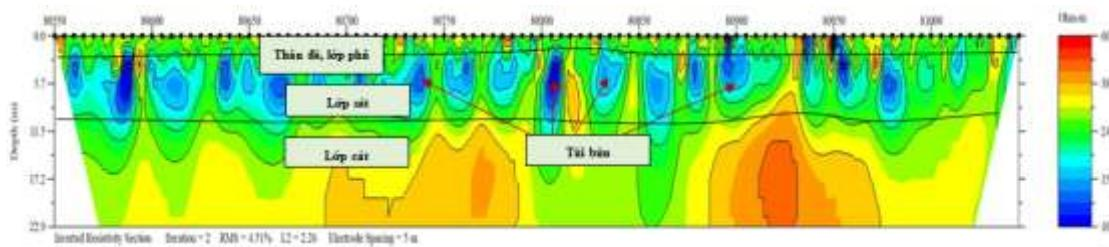
Hình 17. Kết quả khảo sát tuyến rìa sông đê hữu Hồng đoạn K80+600 - K81+000.
