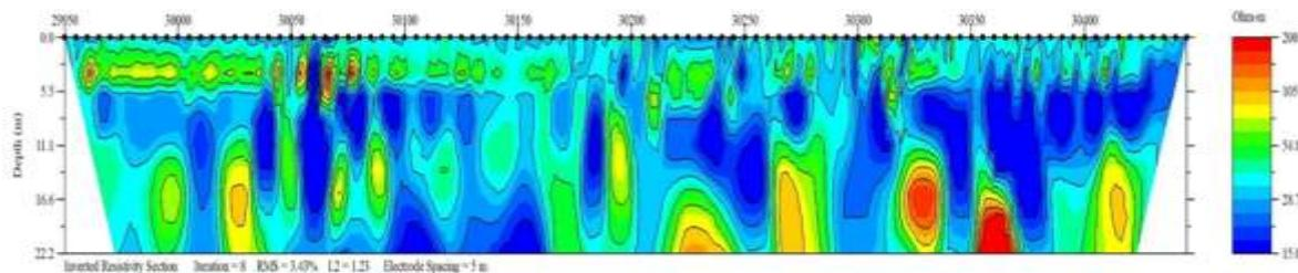
Hình 7. Kết quả khảo sát tuyến rìa sông đê hữu Cầu đoạn K30+000 - K30+400.
