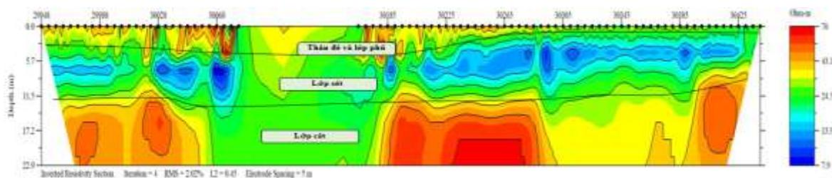
Hình 6. Kết quả khảo sát tuyến cơ đê phía đồng đoạn K29+950 - K30+450.
