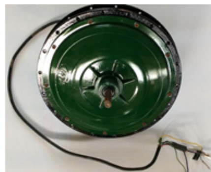
Hình 6: Động cơ điện BLDC được dùng cho xe thực nghiệm
