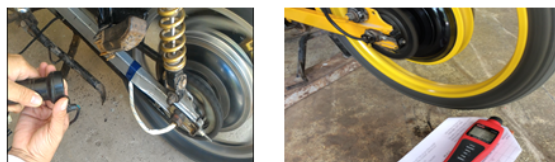
Hình 17: Thử nghiệm xe chạy ở chế độ chỉ động cơ điện
