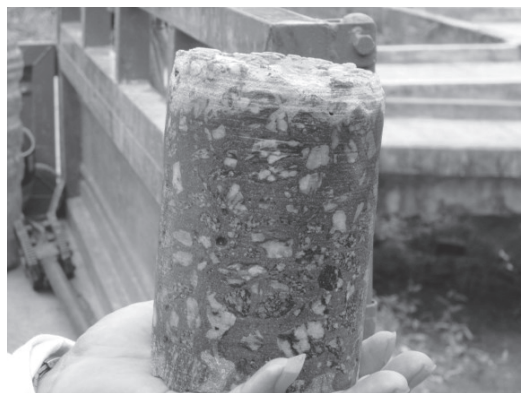
Hình 2. Sau khi phun dung dịch phenolphthalein
