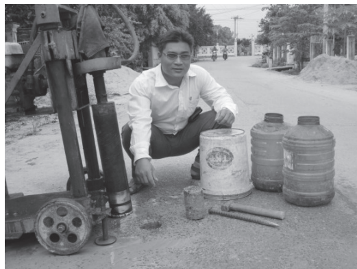
Hình 1. Khoan mẫu bê tông
