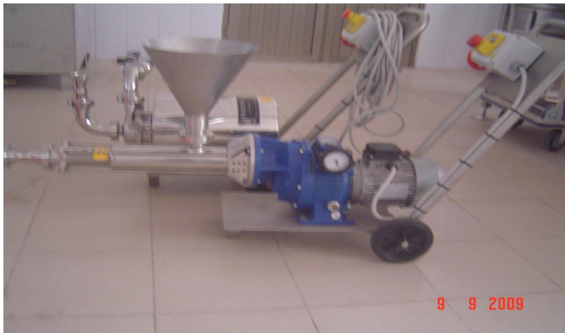
Cấu tạo:khoang chứa (hệ thống trực vít nối liền với động cơ),phễu chứa nguyên liệu vào và đưa ra của bơm.
