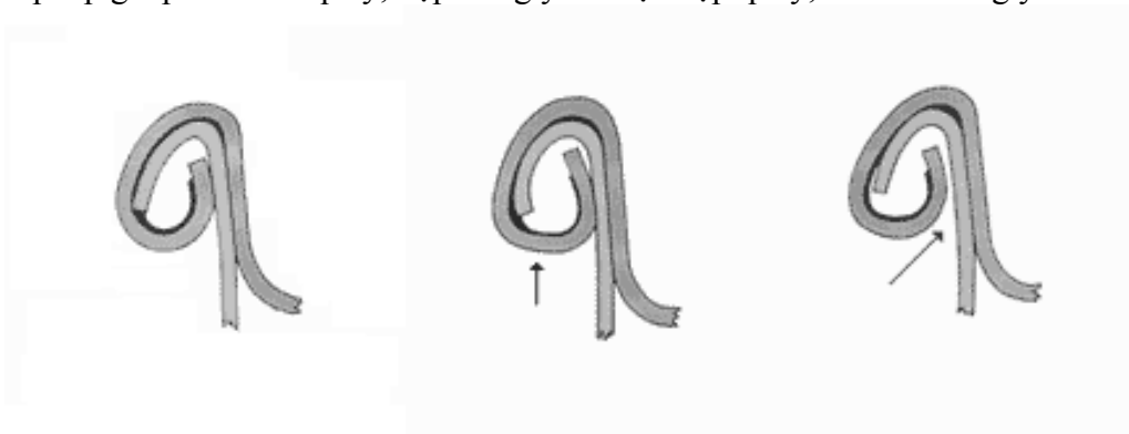
Hình V- 18. Mỗi ghép sơ bộ bình thường, mỗi ghép quá chặt và mỗi ghép lỏng
