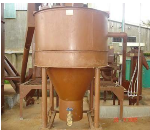
Hình 1.46 : Bể siphon phân loại
