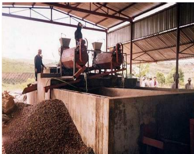
Hình 1.18 : Thùng chứa bằng bê tông cốt thép
