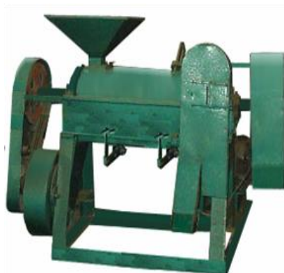
Hình 1.29: Máy sát vỏ kiểu trục
