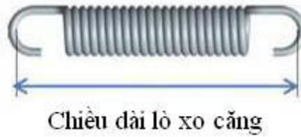
Hình 109. Cấu tạo lò xo căng
