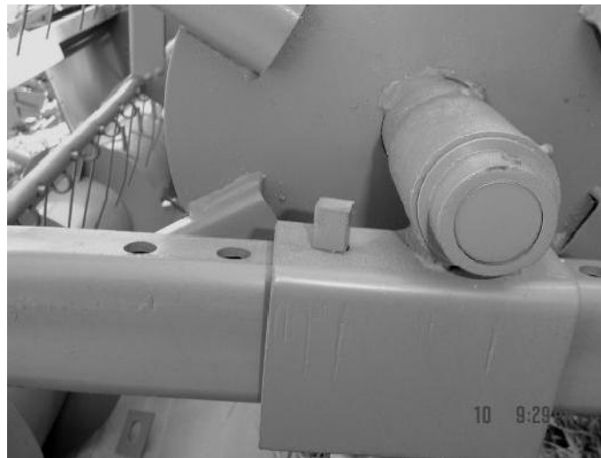
Hình 92. Điều chỉnh vị trí guồng gạt Máy GDLH JohnDeer R40
