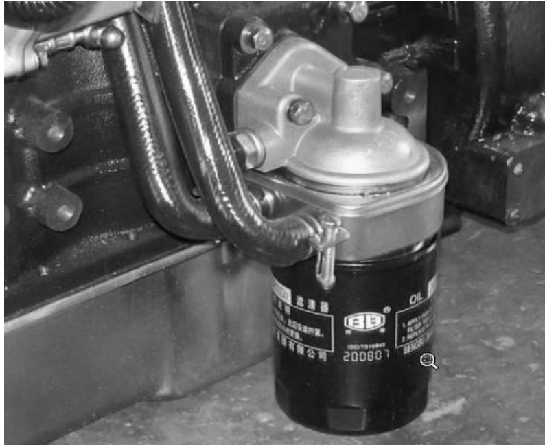
Hình 165. Bình lọc dầu bôi trơn động cơ Máy GDLH JohnDeer R40
