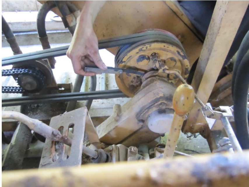
Hình 178. Điều chỉnh bộ ly hợp bằng cách vặn đai ốc
