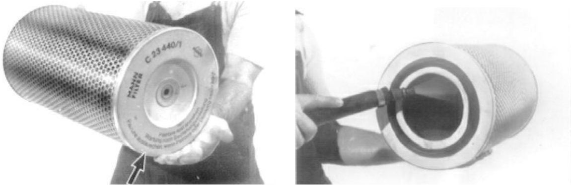
Hình 160. Làm sạch lõi Bình lọc không khí Máy GDLH JohnDeer R40
