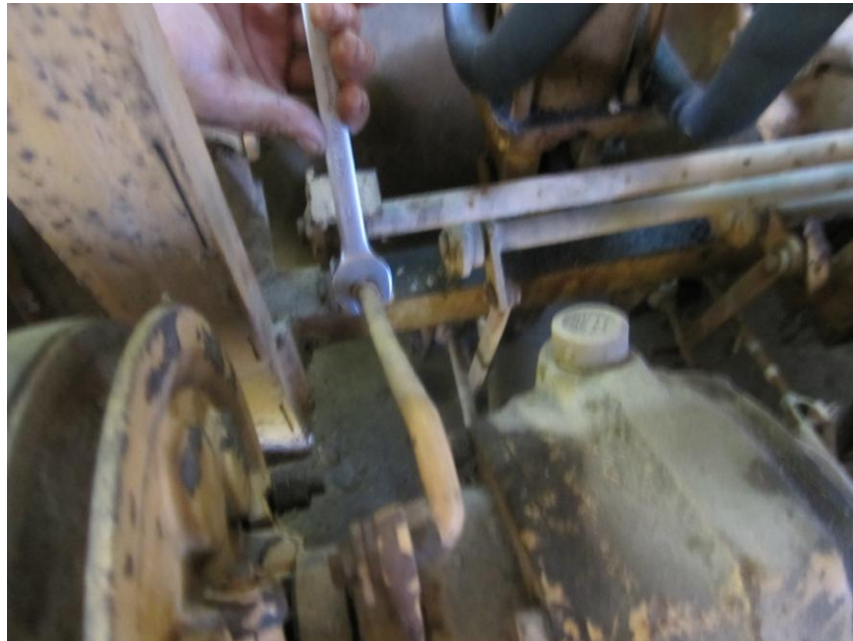
Hình 179. Điều chỉnh bộ ly hợp bằng thay đổi độ dài thanh kéo
