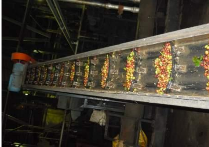
Hình 2.4: Băng tải cao su với các vấu hình vòng cung.
