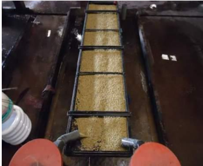
Hình 2.31: Sàng chấn động được gắn kết sau cửa xả liệu của máy đánh nhót
