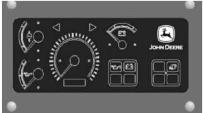
Hình 199. Bảng đồng hồ báo trên máy GDLH John Deere R 40
