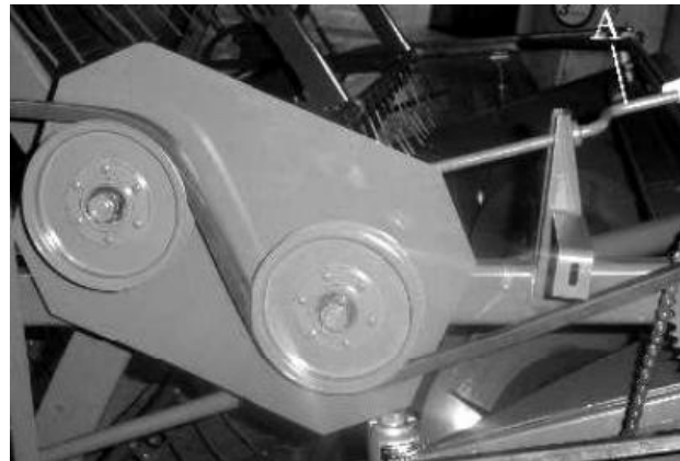
Hình 91. Cơ cấu truyền cho guồng gạt máy GDLH John Deere R 40
