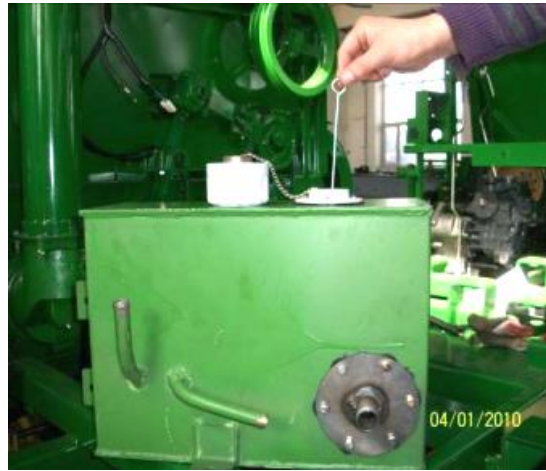
Hình 111. Thùng chứa dầu thủy lực trên máy GDLH John Deere R -40
