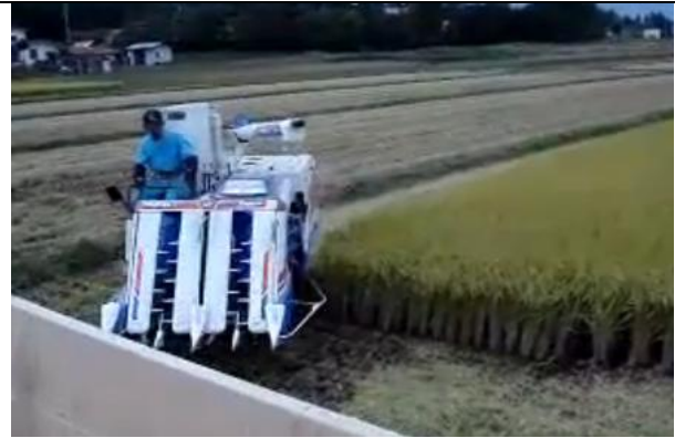
Hình 166. Một máy gặt đang thực hiện phương pháp gặt xung quanh ruộng
