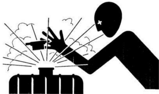
Hình 206. Cảnh thận khi tiếp xúc với hệ thống làm mát động cơ
