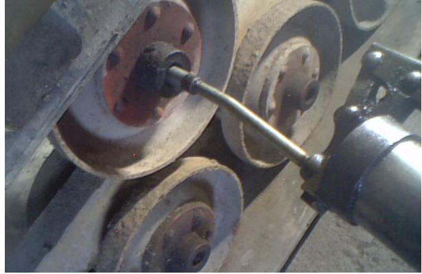
Hình 83. Bánh đỡ xích trên MGĐLH GLH 0,2
