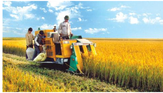
Hình 32. Máy GDLH loại không dùng guồng gạt
