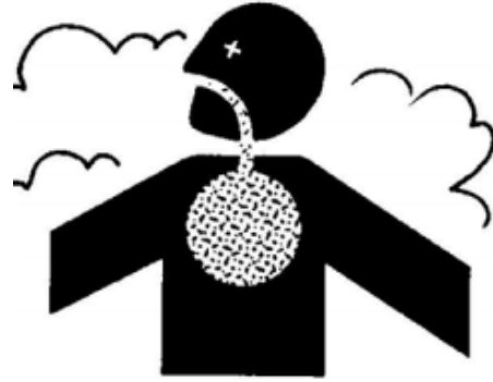
Hình 224. Đề phòng ngộ độc khí xả khi cho động cơ làm việc trong phòng kín
