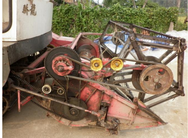
Hình 120. Bộ phận cắt trên máy GDLH
