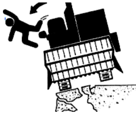
Hình 170. Cẩn thận khi di chuyển ở nơi có nguy cơ sạt lở
