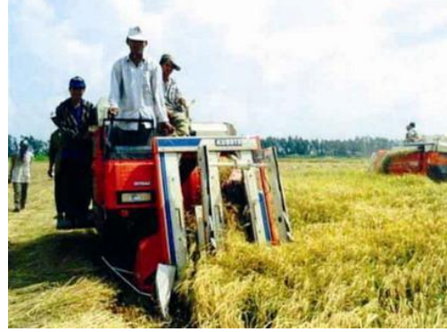
Hình 44. Máy GDLH chuyển lúa bằng bánh hình sao kết hợp với xích chuyên
