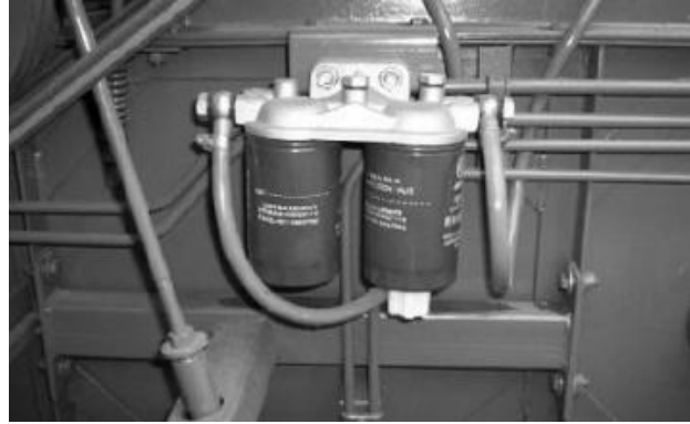
Hình 117. Bình lọc nhiên liệu trên máy GĐLH John Deere R-40
