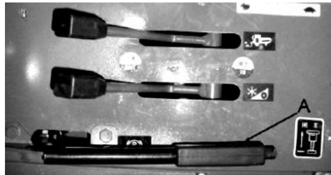
Hình 105. Tay điều khiển li hợp gặt và li hợp đập trên máy GDLH John Deere R -40
