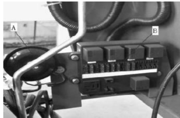
Hình 200. Còi báo hiệu trên máy GDLH John Deere R 40
