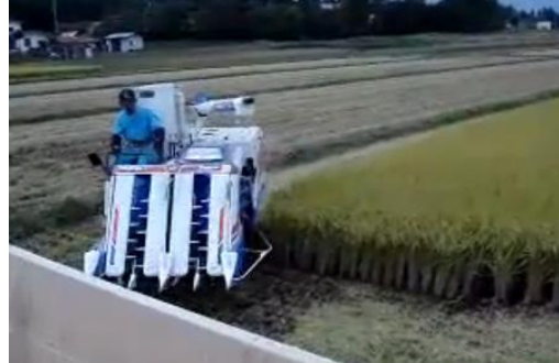
Hình 128. Một máy gặt đang thực hiện phương pháp gặt xung quanh ruộng
