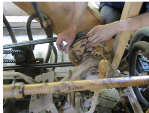
Hình 232. Kiểm tra bộ li hợp khi bị trượt
