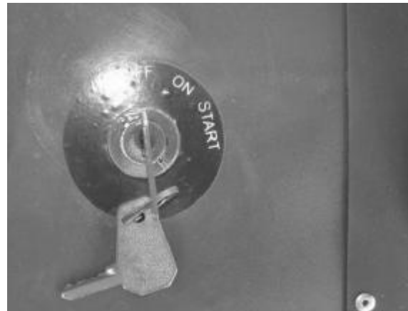
Hình 114. Ổ khóa điện trên máy GDLH John Deere R - 40
