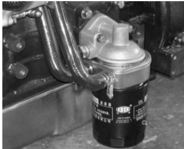
Hình 116. Bình lọc dầu bôi trơn động cơ trên máy GDLH John Deere R-40
