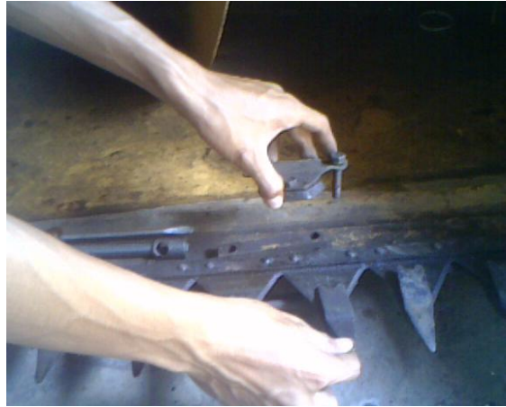
Hình 38. Lắp tấm đè dao trên bộ phận cắt.
