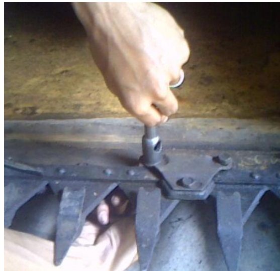
Hình 37. Kiểm tra, xiết chặt tấm dè dao.
