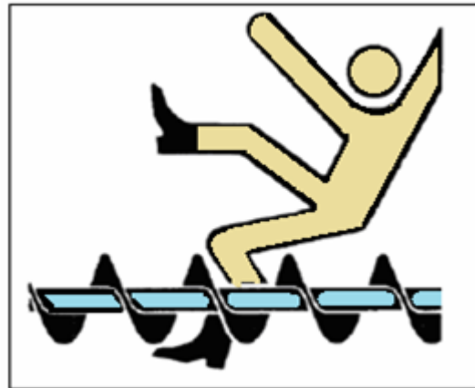
Hình 230. Cảnh thận khi mở và làm sạch bộ phận chuyển lúa hạt
