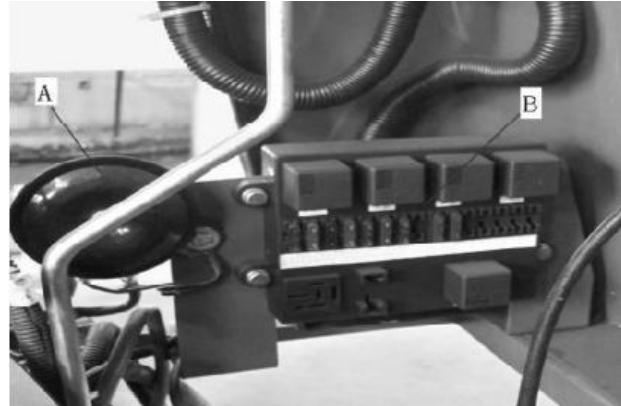
Hình 118. Hộp cầu chì và còi báo hiệu trên máy GĐLH John Deere R-40
