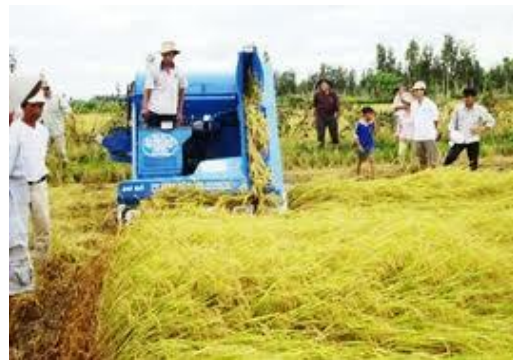
Hình 45. Máy GDLH chuyển lúa bằng bánh hình sao kết hợp với xích chuyên.
