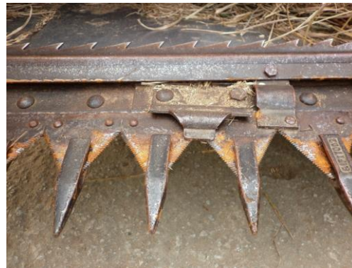
Hình 210. Một phần của bộ phận cắt trên máy GDLH
