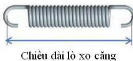
Hình 45. Cấu tạo lò xo căng
