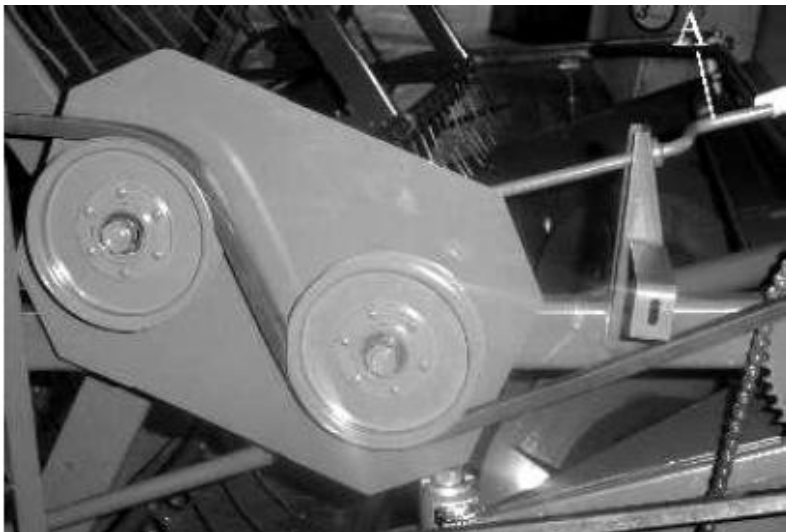
Hình 40. Điều chỉnh độ căng dây đai truyền động guồng gạt máy GDLH JohnDeer R40
