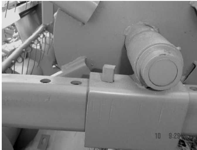
Hình 8. Điều chỉnh vị trí guồng gạt máy GDLH JohnDeer R40
