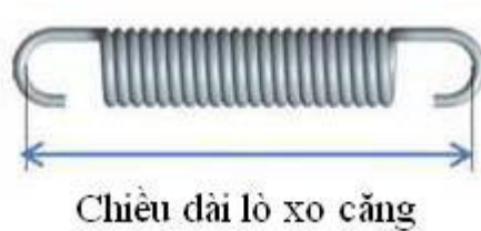
Hình 35. Cấu tạo lò xo căng
