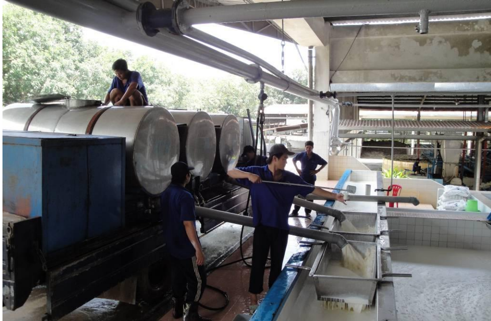
Hình3-3 : Xả mủ từ trên xe chảy qua rây lọc vào mương tiếp nhận
