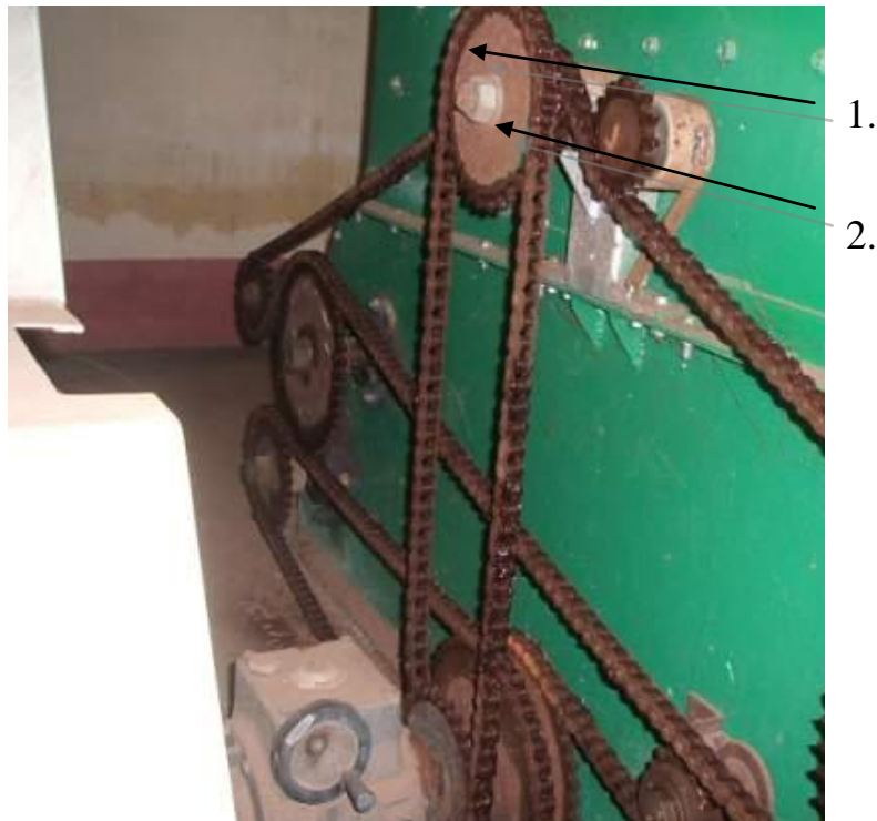
Hình 3.7: Bộ phận truyền động 1. Bánh răng, 2. Dây đai truyền động
