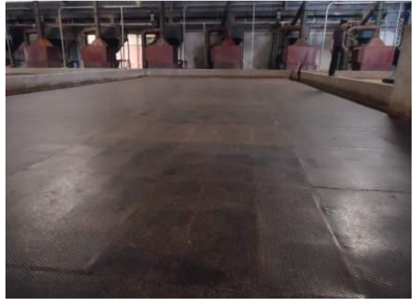
Hình 3.9: Máy sấy tĩnh 1. Lò đốt; 2. Quạt hút nhiệt; 3. khay sấy
