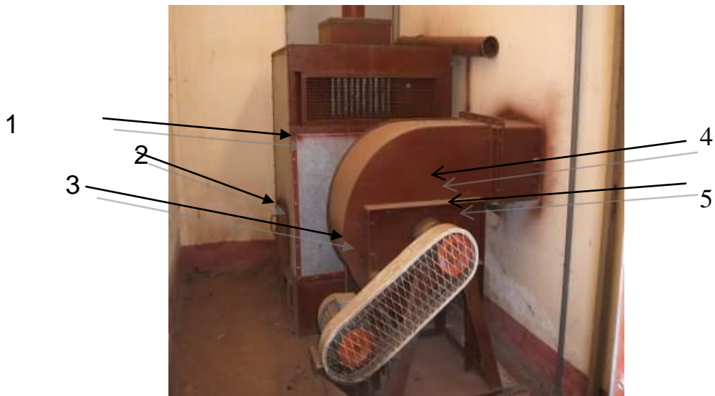
Hình 3.10: Lò đốt bằng than đá 1. Cửa lò; 2. Cửa tháo tro; 3. Mô tơ; 4. Cửa thông gió; 5. Quạt gió
