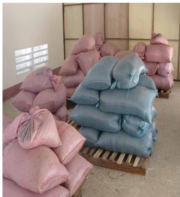
Hình 5.15. Cách xếp bao cà phê trên pallet gỗ
