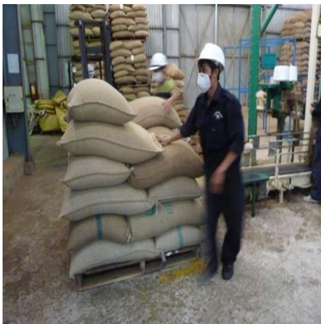
Hình 5.15. Cách xếp bao cà phê trên pallet gỗ
