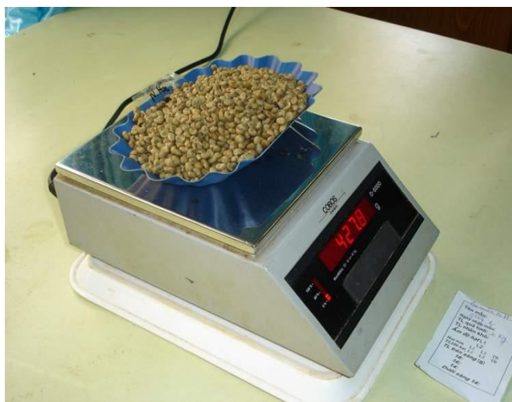
Hình 5.23. Cân mẫu chung trước khi đo độ ẩm hạt
