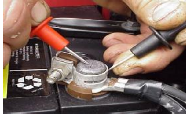
Hình 28. Kiểm tra sụt áp kẹp
