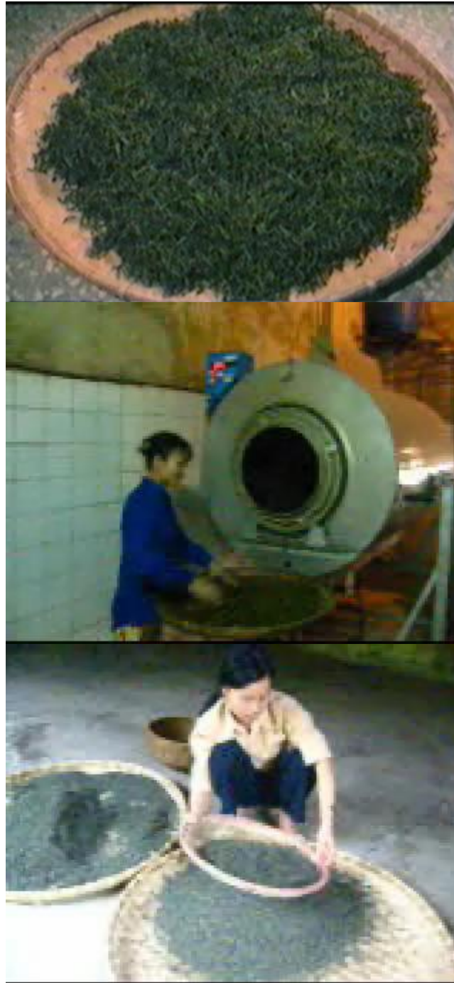
H4-11: Nạp chè vào máy sao và sàng tách phần chè vụn giữa các lần sao
