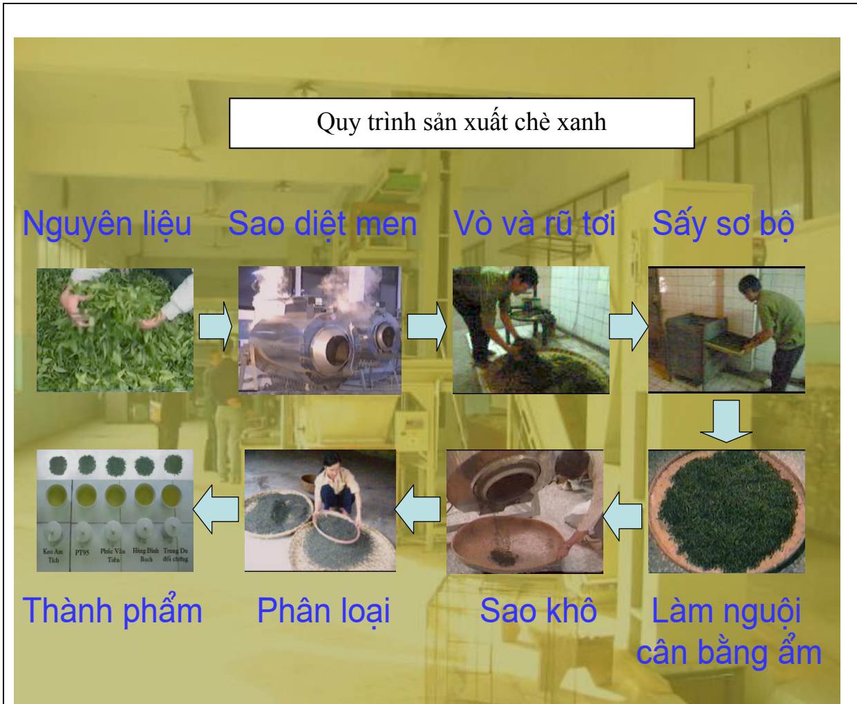
H4-01: Các công đoạn trong quy trình sản xuất chè xanh bằng hình ảnh
