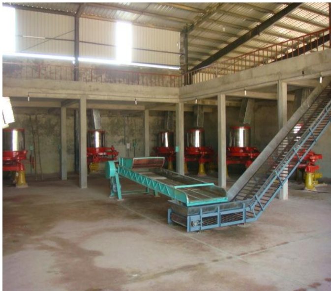
H5-07: Hệ thống máy vò và sàng tơ chè đen OTD
