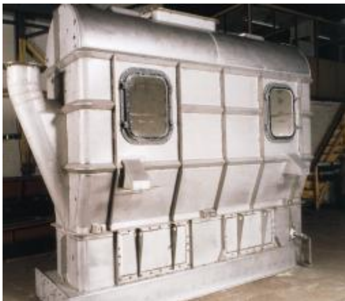
Hình 2.13 : Thiết bị sấy tầng sôi dùng trong sấy đường
