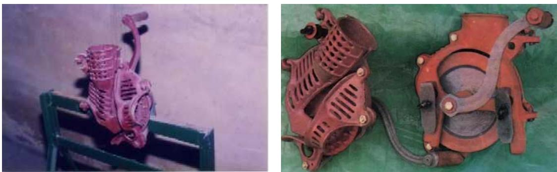
Công cụ tẽ ngô quay tay được Viện Cơ điện Nông nghiệp thiết kế và chế tạo theo mẫu của nước ngoài (từ 1991). Hiện nay nhiều cơ sở sản xuất cơ khí đã chế tạo hàng loạt với số lượng lớn để phục vụ sản xuất. Công cụ tẽ ngô quay tay có kết cấu đơn giản, dễ chế tạo, giá thành rẻ, phù hợp với quy mô sản xuất hộ gia đình ở các tỉnh miền núi và đồng bằng không chuyên canh ngô.
