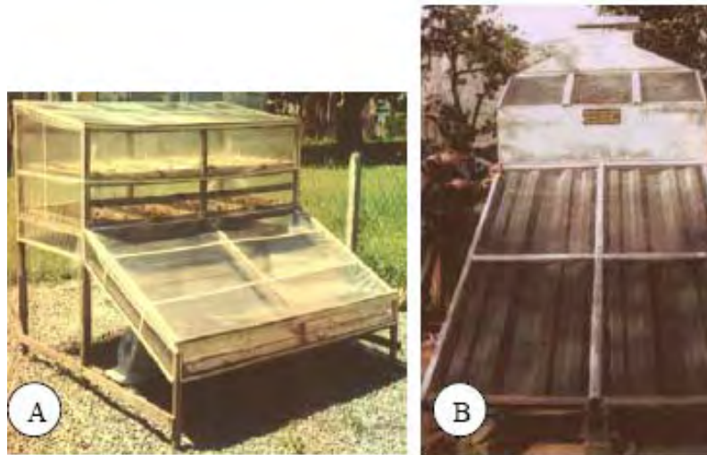
Hình 15. Máy sấy năng lượng mặt trời kiểu buồng (A) và mẫu được cải tiến (B)
