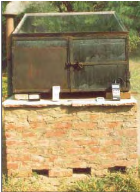
Ảnh 11. Máy sấy hỗn hợp năng lượng mặt trời – sinh khối (trái) và kết cấu bên trong (phải) (Prasad và Vijay, 2005)
