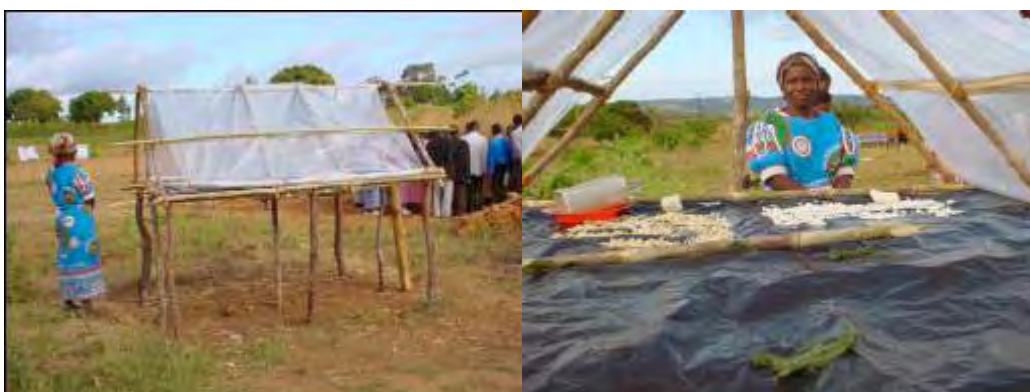
Ảnh 5. Máy sấy đơn giản dùng năng lượng mặt trời với các tấm phủ bằng plastic
