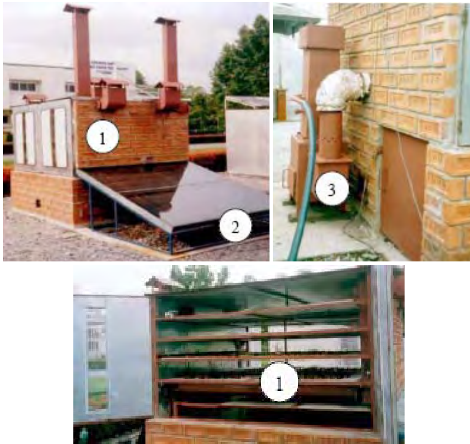
Ảnh 17. Hệ thống sấy hỗn hợp năng lượng mặt trời – năng lượng sinh khối (1- Buồng sấy, 2- Bộ phận thu năng lượng mặt trời, 3- Bộ phận đốt năng lượng sinh khối)
