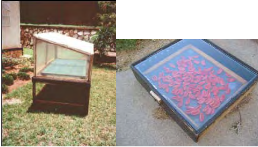
Ảnh 2. Sấy trực tiếp bằng năng lượng mặt trời – kiểu buồng (trái) và kiểu hộp (phải)
