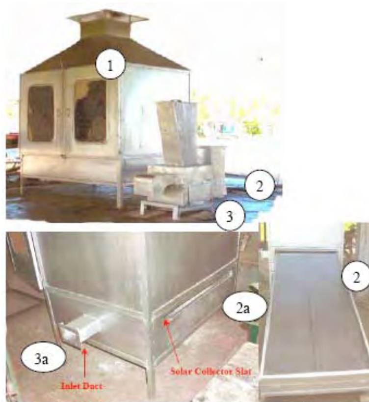
Ảnh 16. Máy sấy hỗn hợp FD-50 có bộ phận thu nhiệt và bộ phận sử dụng năng lượng sinh khối (1- Buồng sấy, 2- Bộ phận thu nhiệt mặt trời, 3- Lò đốt năng lượng sinh khối,
