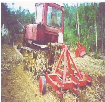
Hình 31: Xới sâu (cày ngấm) XL-1,8 do Viện Cơ Điện NN & CNSTH thiết kế chế tạo
