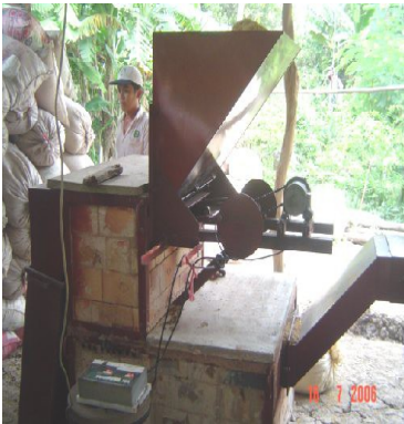
Hình 23: Lò đốt trấu tự động cho máy sấy đảo chiều SRA-4
