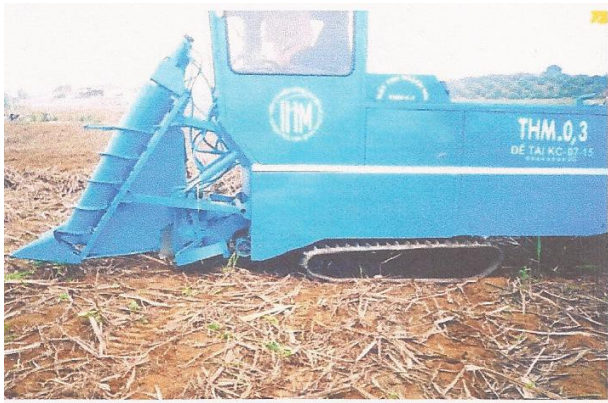
Hình 38: Máy thu hoạch mía tự hành cỡ trung THM-0,3
