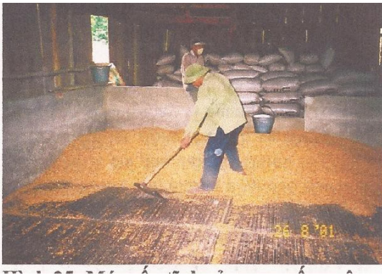
Hình 25: Máy sấy tĩnh vĩ ngang sấy ngô thương phẩm tại Sơn La; có khoảng 40 máy sấy cỡ này (2001) sấy được khoảng 15% sản lượng ngô thu hoạch trong tỉnh.
