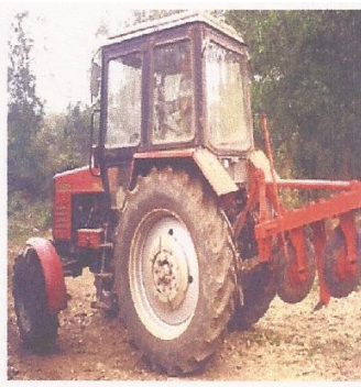
Hình 32: Xới sâu phối hợp với cày 3 chảo, liên hợp máy kéo MTZ-892
