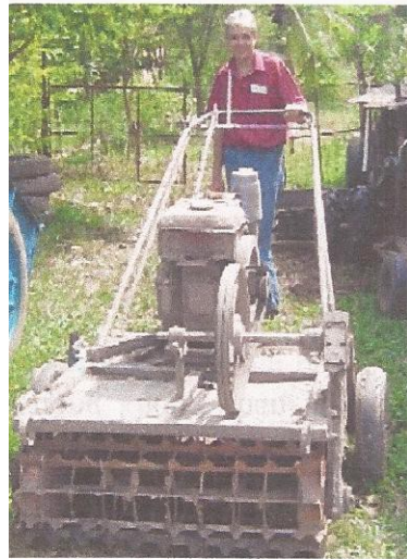
Hình 4: Máy trục bùn (Hydrotiller) với động cơ diesel, chế tạo tại CỬ CHI, TP HCM
