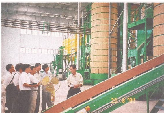
Hình 27: Máy sấy Westrup dạng thân trụ, tại Công ty Giống Thái Bình.
