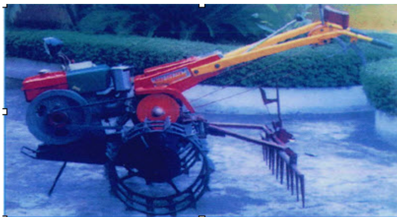
Hình 34: Bừa răng liên kết với máy kéo cầm tay
