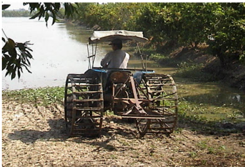
Hình 30: Máy kéo 4 bánh lắp bánh lồng để làm nhỏ đất
