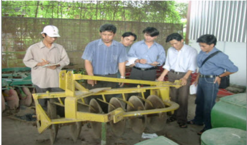
Hình 27: Cày chảo loại treo có các đĩa lắp trên một trục
