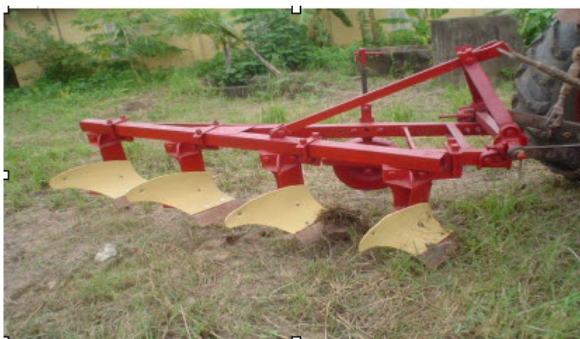
Hình 25: Cày lưỡi diệp CT-4-25 liên hợp với máy kéo MTZ 50/52; MTZ 80/82
