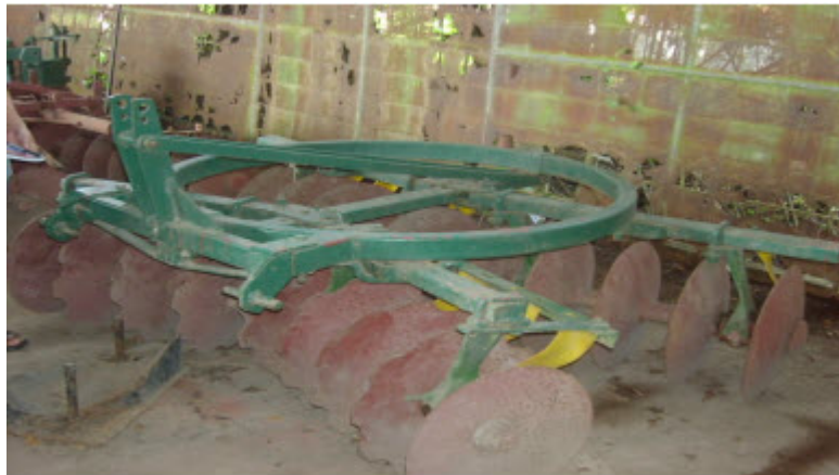
Hình 35: Bừa đĩa chỏm cầu có cạnh sắc dạng cạnh khế lắp trên máy kéo lớn 40 – 50 Hp
