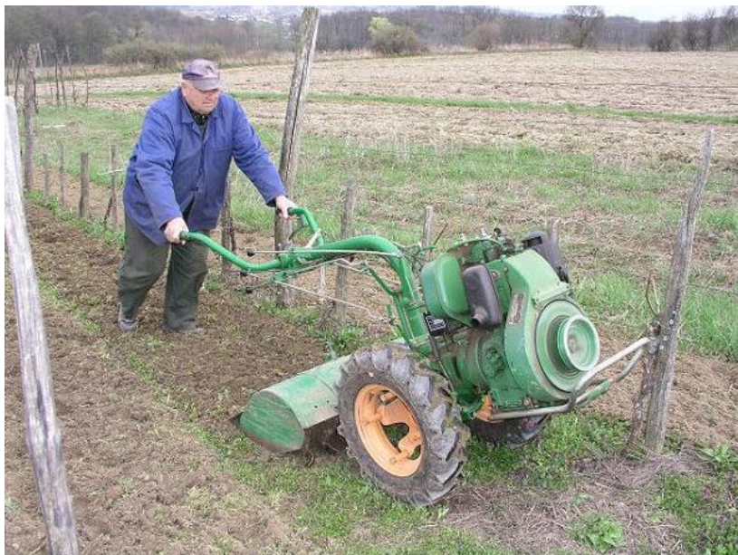
Hình 40: Cụm phay làm việc với máy kéo hai bánh được che chắn
