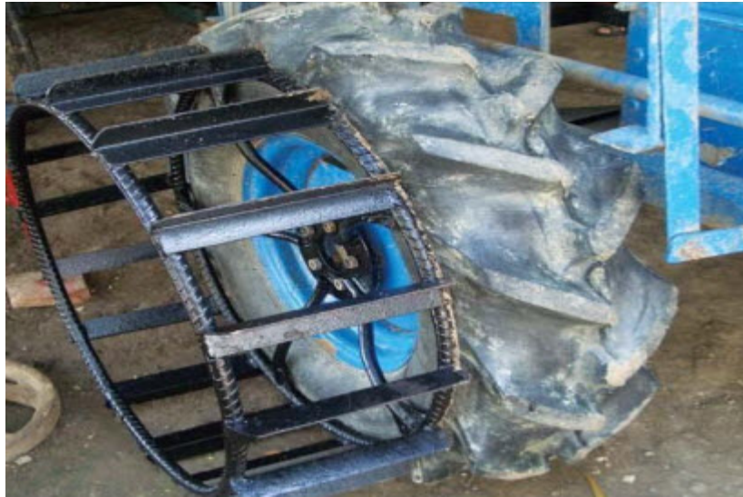
Hình 31: Bánh lốp lắp kèm vào bánh lốp để di chuyển trên ruộng lầy lội
