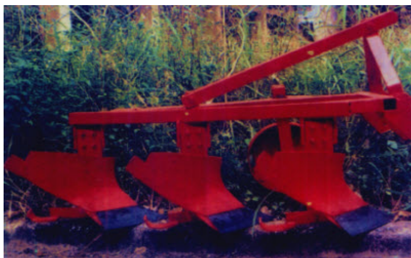
Hình 26: Loại cày treo lưỡi diệp liên hợp với máy kéo cỡ trung 30 – 35 Hp
