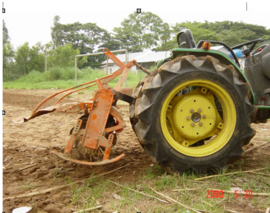
Hình 41: Nâng tấm che chắn của phay tỳ điều kiện làm việc
