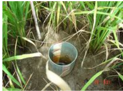
Hình 3a,3b: Đặt ống và thước để theo dõi mực nước trong ruộng
