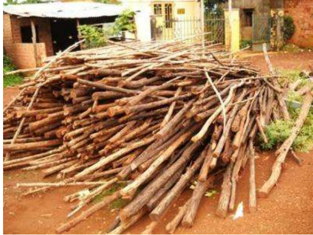
Hình 1.1.16. Thân bời lời sau khi đẽo vỏ được dùng trong xây dựng
