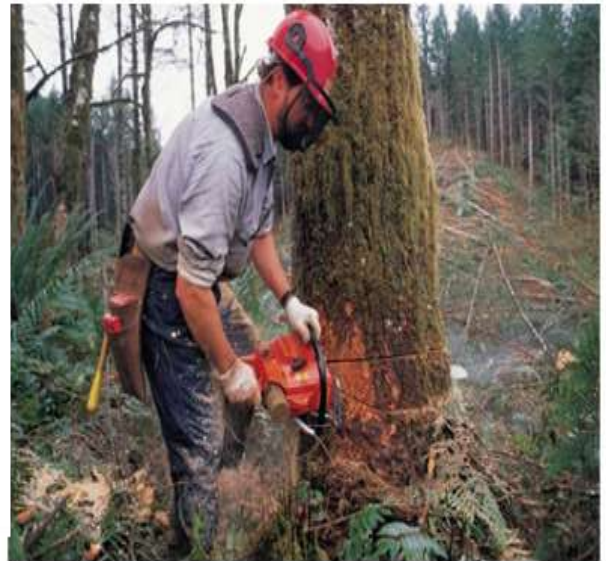
Hình 5.1.18: Quá trình hạ cây bằng cưa xăng
